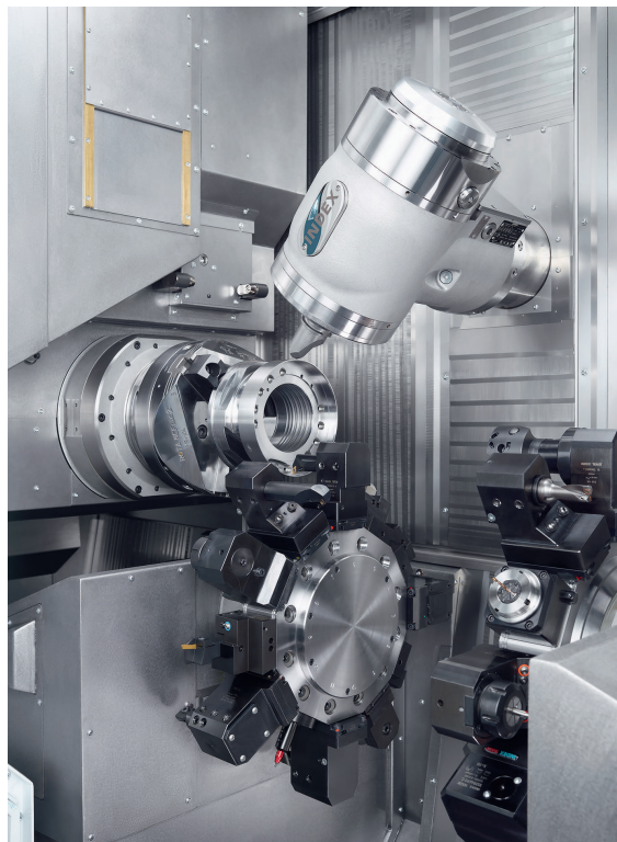
3 Drehen und Fräsen hochproduktiv vereint: hier am Beispiel des Arbeitsraums des Drehfräszentrums Index G220 © Index-Werke
